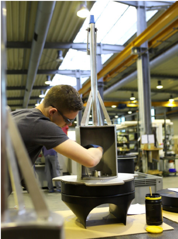
Bild 2: Montage des Sender-Einsatzes für eine Quick-Pig-Molchstation
